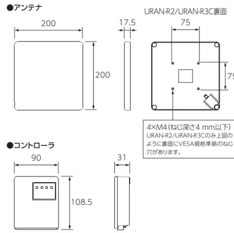
\*アンテナ固定用治具(B-URANR1-01)の寸法図については当社HPをご確認ください。
